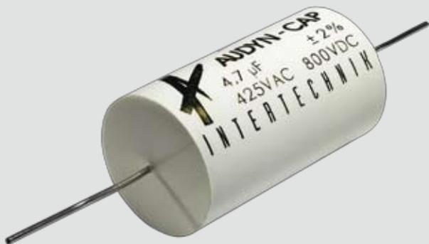
Kondensator mit Polypropylenfolie, wobei 2 getrennte Wicklungen in Reihe geschaltet sind. Hierdurch wird ein induktionsfreier und dämpfungsarmer Aufbau erreicht.
