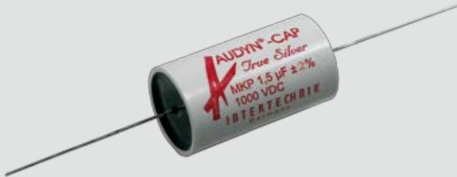
Kondensator mit Silber Metallisierter Folie. Dielektrikum: Polypropylenfolie. Intern reihengeschalteter Aufbau. Selbstheilend. Stabiler, runder Aufbau.
