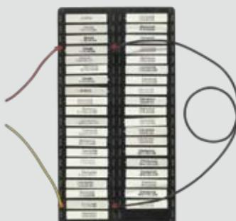
Widerstandsdekade für Entwicklungszwecke. Auch zur Parallel- und Reihenschaltung mit Werten im Bereich 0,1 bis 100 Ohm.
