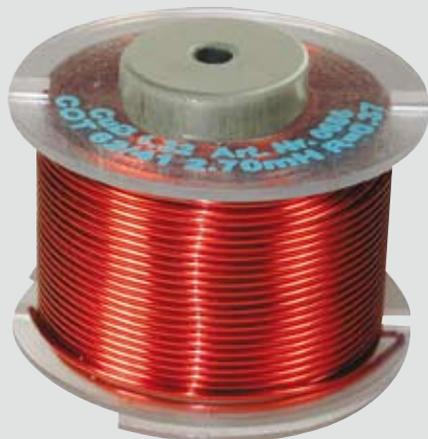
Backlackspulen werden aus einem speziellen Draht (Thermoplastdraht) gefertigt. Eine zusätzliche Lackschicht auf diesem Draht wird während oder nach dem Wickelvorgang mittels Heißluft oder eines Stromstoßes zum Schmelzen gebracht. Der Effekt ist vergleichbar mit dem Vakuumtränken. Durch diese Wickeltechnik wird eine vibrationsfreie Spulenumwicklung erreicht.
