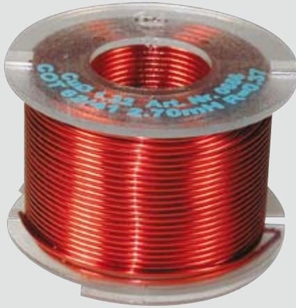
Backlackspulen werden aus einem speziellen Draht (Thermoplastdraht) gefertigt. Eine zusätzliche Lackschicht auf diesem Draht wird während oder nach dem Wickelvorgang mittels Heißluft oder eines Stromstoßes zum Schmelzen gebracht. Der Effekt ist vergleichbar mit dem Vakuumtränken. Durch diese Wickeltechnik wird eine vibrationsfreie Spulenkörper erreicht.
