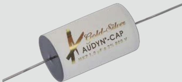
Kondensator mit Polypropylenfolie, wobei 2 getrennte Wicklungen in Reihe geschaltet sind. Hierdurch wird ein induktionsfreier und dämpfungsarmer Aufbau erreicht.
